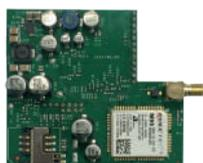
Modulo GSM per l'estensione della comunicazione del combinator CT-BUS alla rete GSM.
