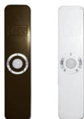
**Rivelatore via radio, IR a tenda da interno**, per la protezione di porte e finestre.
