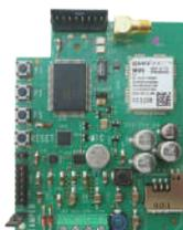
Combinatore telefonico digitale con sintesi vocale integrata per la telegestione su linea telefonica GSM delle centrali DEFENDER WEB, HYBRID WEB e DEFENDER24.
